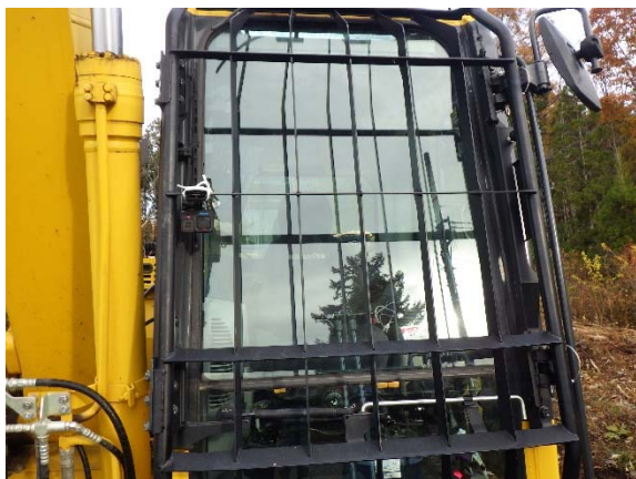
写真 3-15 フロントフルガード（左）とキャブ内部からの視界（右）
