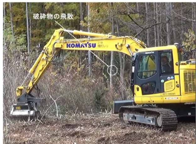
図 3-28 破砕物の飛散（マルチャー左旋回時） 海外事例等では、小石などが 100m ほど飛来した事例がある
