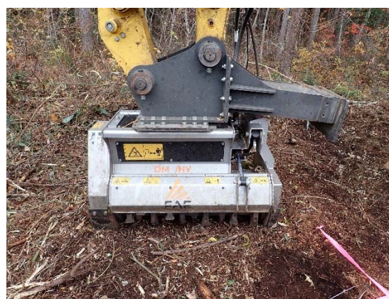
写真 3-1 ベースマシン PC138US-11 マシンガイダンス仕様（左）とマルチャー DML/HY-100VT（右）
