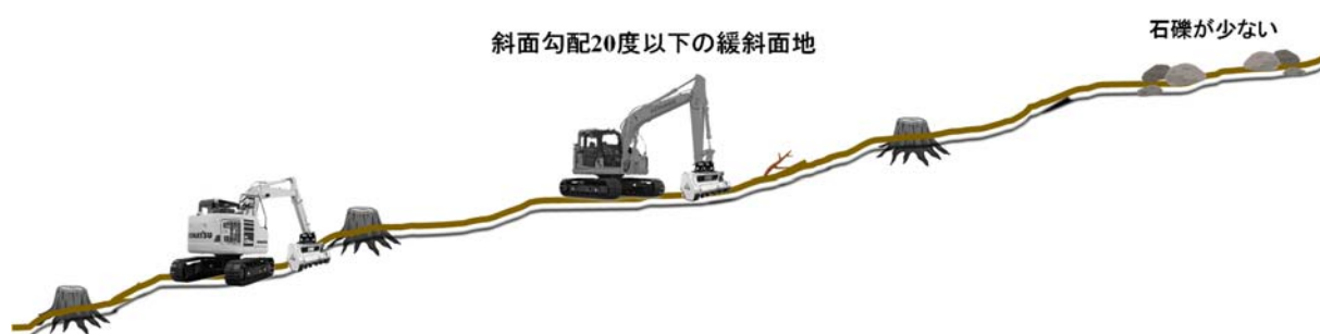
図 3-32 PC138US-11 マシンガイダンス機導入の立地条件
