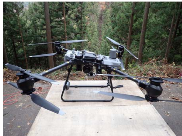
写真4-3 離着陸台に設置された Fly Cart 30
