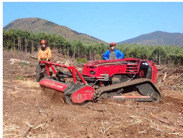
写真 1-15 後退破碎による地表面仕上げ状況（左）と後退破碎機械状況（機械装着 GoPro 画像）
