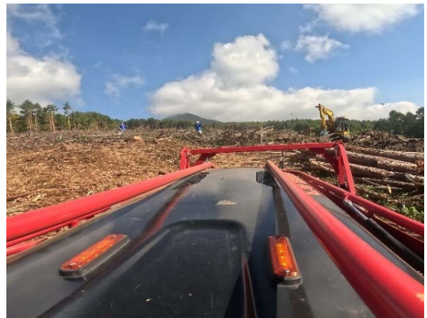
写真 1-15 後退破碎による地表面仕上げ状況（左）と後退破碎機械状況（機械装着 GoPro 画像）
