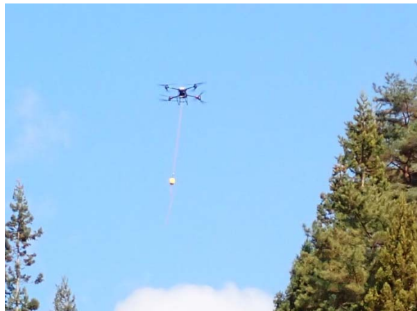
写真 4-10 第1回目飛行（左：先柱地点ビデオ画像、右：牽引バケット） 牽引バケット（10 kg：機体下黄色バケット）にナイロンロープ結束して飛行
