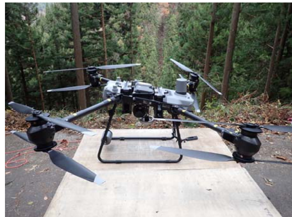
写真4-3 離着陸台に設置されたFly Cart 30
