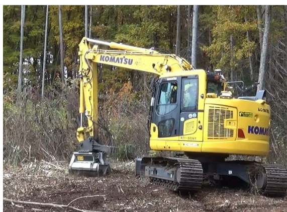
写真 3-1 ベースマシン PC138US-11 マシンガイダンス仕様（左）とマルチャーDML/HY-100VT（右）
