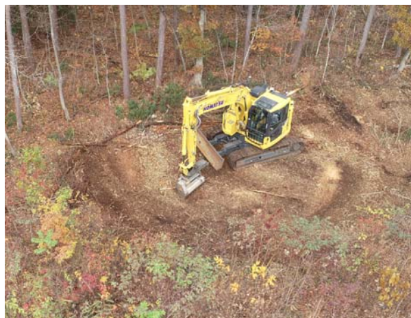
写真 3-14 PC138US-11 マシンガイダンスマルチャー地拵えによる平滑林床形成
