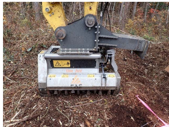
写真3-9 マルチャー接続部のステイ
