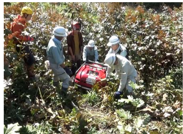
写真 2-18 切株乗り上げによる脱出状況
