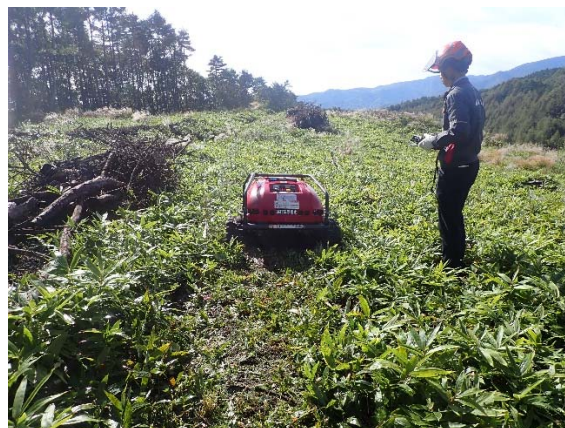
写真 2-2 刈幅 700 mm デモンストレーション時 (2025. 10. 2)
