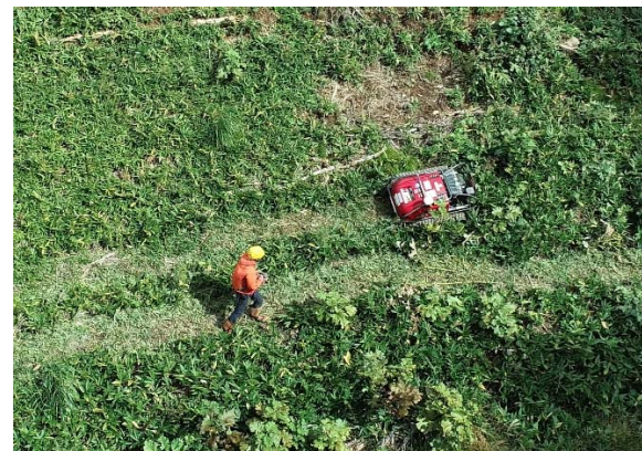
写真 2-19 視界不良の草本優先区での機体下方での操作（左）と視界が良好なササ優占区での距離を置いての操作（右）
