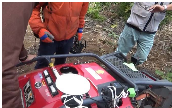
写真2-5 ビデオカメラ(GoPro)とGNSS受信機(DG-PRO1RW)
