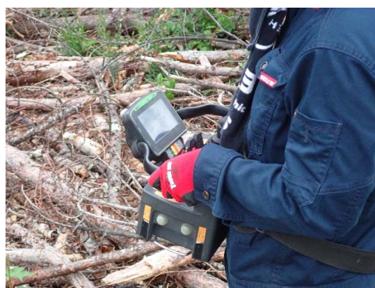
写真 1-3 ラジコンプロポーショナル:送信機コントローラー
