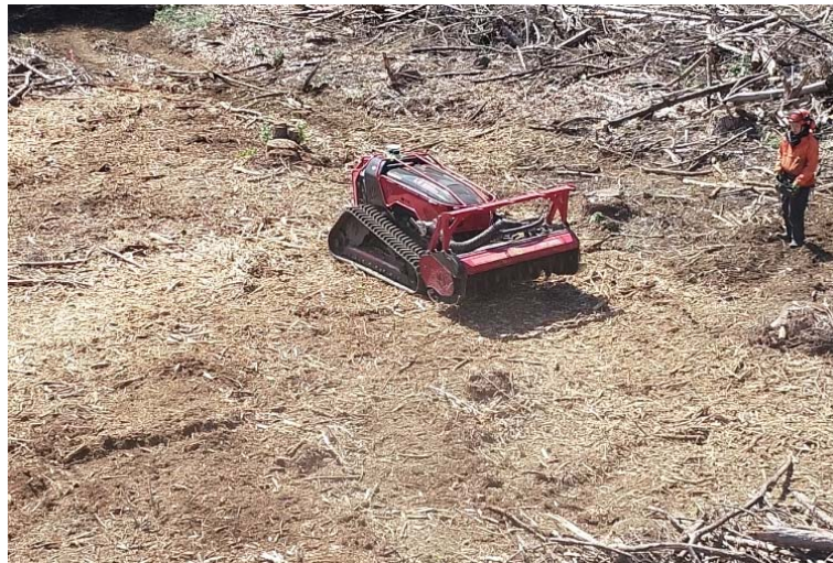
写真 1-20 LV-800 地拵えによる平滑な林床
