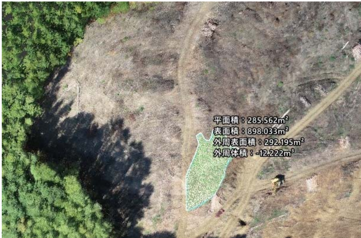
図 1-9 実証調査地の状況 実施前後によるドローンレーザ計測比較計算
