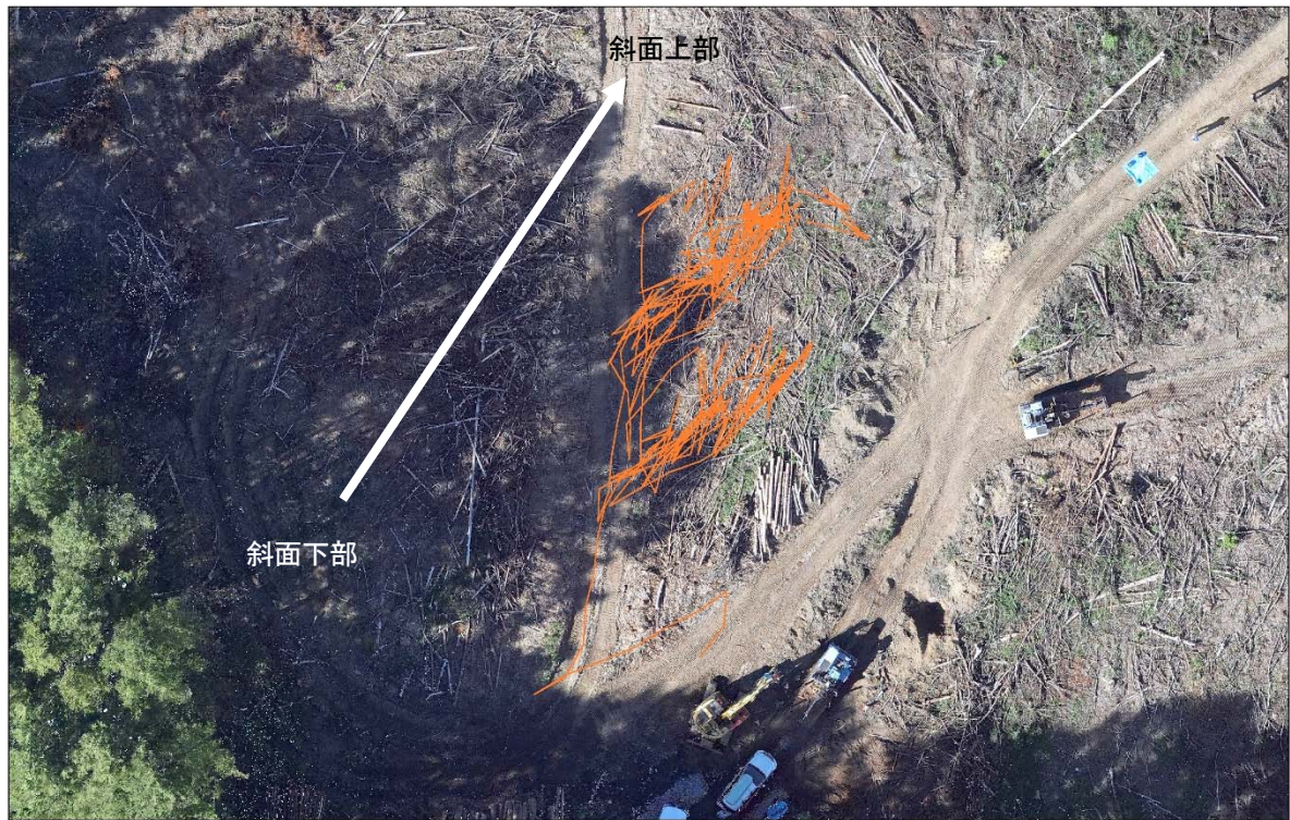
図 1-5 LV-800 の稼働（移動）軌跡
