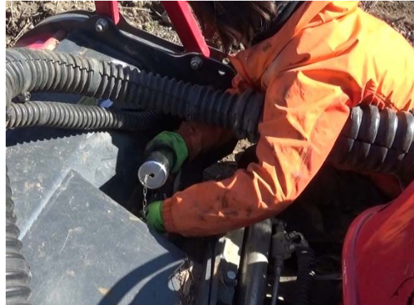
写真 1-18 グリスの補充 (午前作業終了後)
