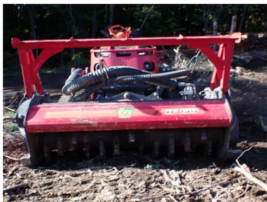
写真 1-2 ローター幅 (1,460mm) のフォレストアタッチメント
