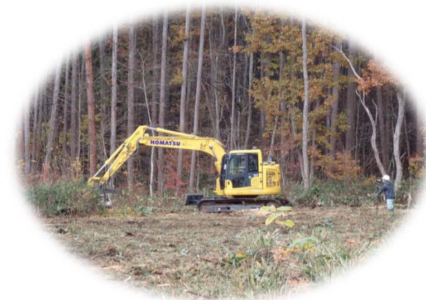
マシンガイダンス機マルチャー地拵え PC138US-11 マルチャーDML/HY-100VT
