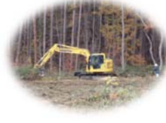
マシンガイダンス機マルチャー地拵え PC138US-11 マルチャーDML/HY-100VT
