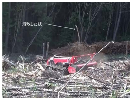
実証作業中もLV-800の後方に直径5cm、長さ1m程度の材が粉碎されずに飛来
