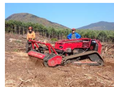
後退破碎による仕上げ
