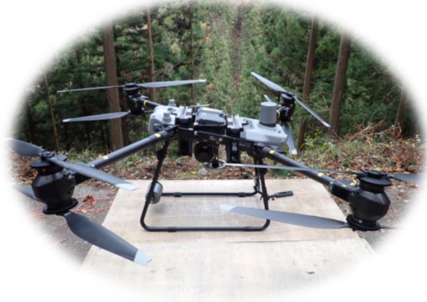
ドローンリードロープ引き回し DJI Fly Cart 30
