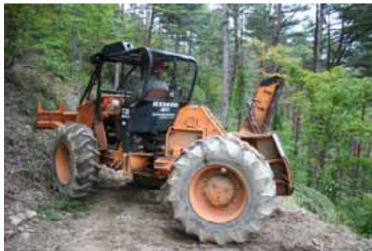
写真 4-66 森林作業道上でのロギングトラクタによる集材とグラップルによる木寄せ作業
