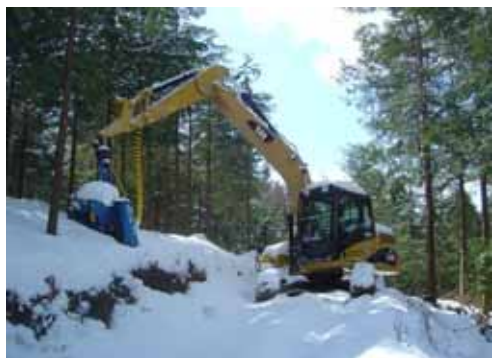
写真 4-4 作業機械の退避 20cm を超す積雪で、作業を中止し、森林作業道の安定した尾根部に退避させたプロセッサ。
