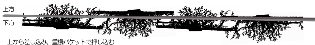
図4-6 根株の盛土法尻への互い違いの設置模式図（断面的）
