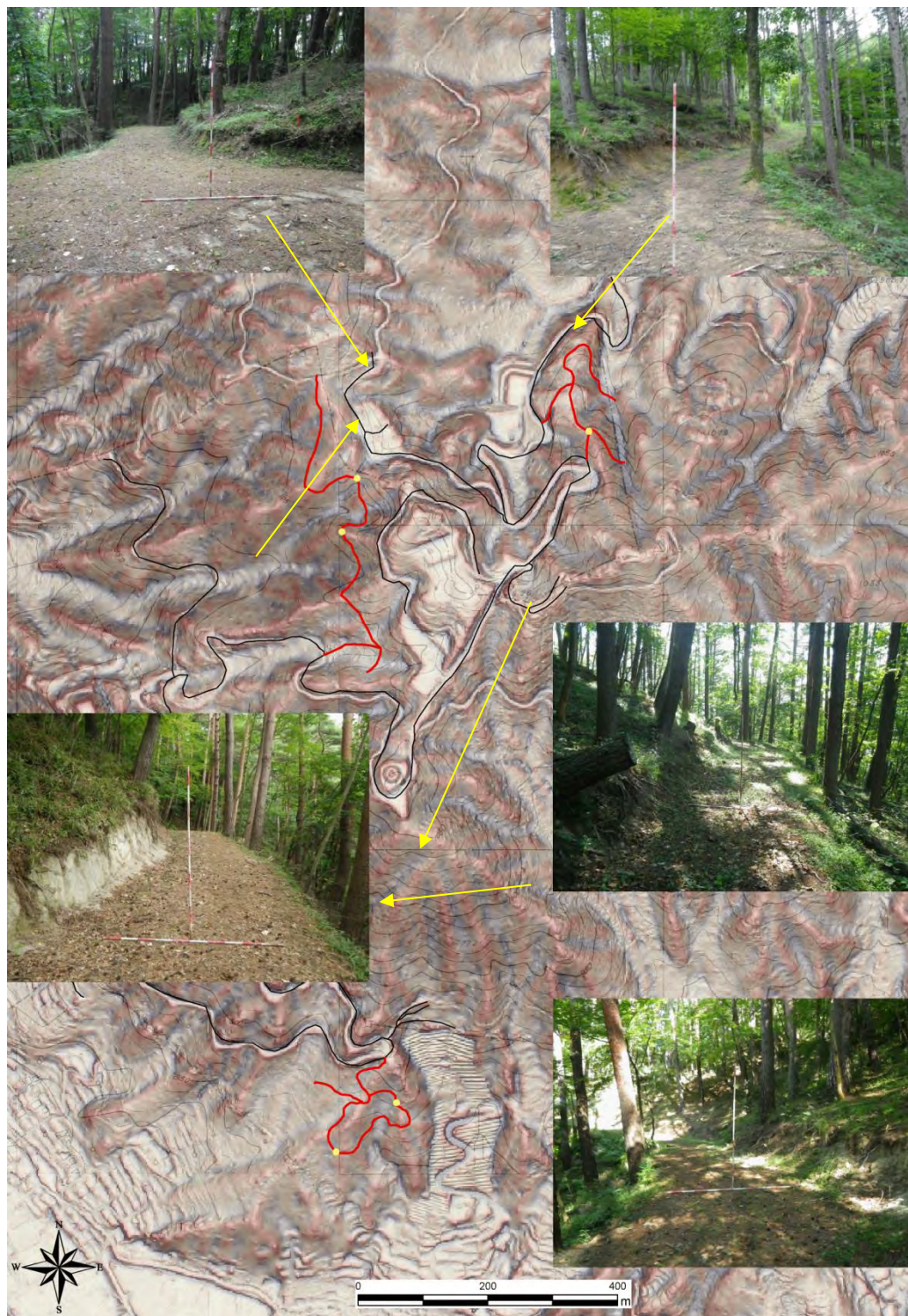
図5-24 路体変状が認められなかった事例
